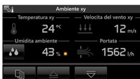
Si la grandeur affichée est l'humidité relative et si l'installation le prévoit, il est possible de définir un point de consigne au-delà duquel une alarme spéciale s'affiche et se déclenche, si nécessaire. Dans la page précédente, on voit que l'indicateur d'état de la sortie ON/OFF peut être absent si le contrôle d'humidité est désactivé dans la page de réglage du point de consigne.
