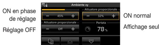
Si l'actionneur est sur OFF, l'affichage est le suivant :
