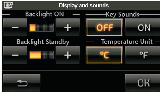
Pour régler le rétro-éclairage, garder le doigt sur les icônes **+** et **-** jusqu'à atteindre le niveau désiré.
