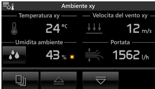
Nel caso la grandezza visualizzata sia l'umidità relativa e se l'impianto lo prevede, è possibile impostare un setpoint al superamento del quale verrà visualizzato, ed eventualmente attivato, un apposito allarme.
