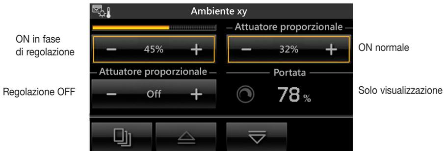
Nel caso in cui l'attuatore si trovi nello stato di OFF, la visualizzazione sarà:
