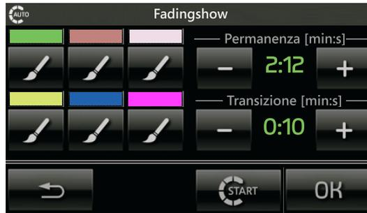
La funzione di Fading-show permette di impostare una sequenza ciclica di colori (fino ad un massimo di 6) per realizzare variazioni cromatiche e giochi di luce negli ambienti dove sono installate le lampade RGB.
