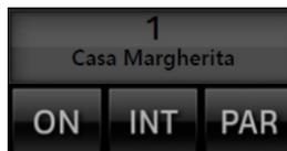
Sia l'icona **OFF** per il disinserimento che quelle **ON**, **INT** e **PAR** per l'inserimento sono utilizzabili o meno a seconda dei permessi associati al codice utente che viene inserito al momento del login.
