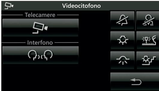
Attraverso la videata **Videocitofono** sarà possibile visualizzare e comunicare con colui che ha effettuato la chiamata ed effettuare l'apertura dell'elettroserratura, l'accensione delle luci scale, effettuare chiamate intercomunicanti con altri videocitofoni e citofoni, attivare autoaccensioni per controllo ambientale, ecc.
