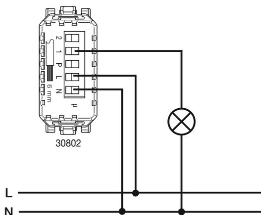
Beispiel eines Lichtkreises mit Tasten und Relais in einer neuen Anlage.
