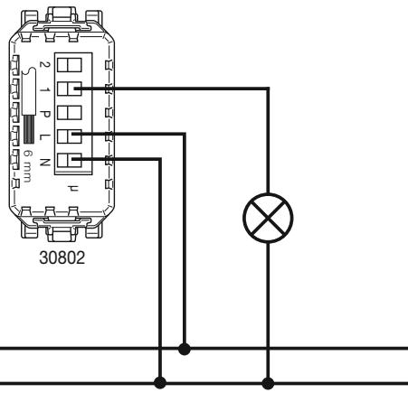
Παράδειγμα κυκλώματος φωτισμού με πλήκτρα και ρελέ σε νέα εγκατάσταση.
