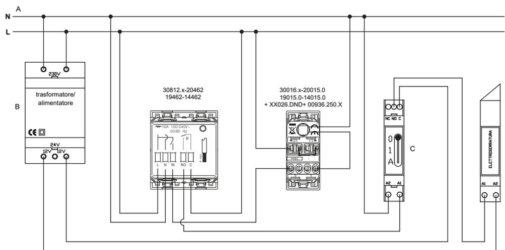
**2. Collegamento in presenza di lettore, tasca (con funzione di scambio relé) e tasto interno camera per DND (con segnalazione integrata)**
