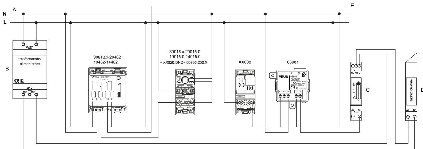
4. Collegamento in presenza di lettore, attuatore connesso (con funzione di scambio relè) e tasto interno camera per DND (con segnalazione integrata)
