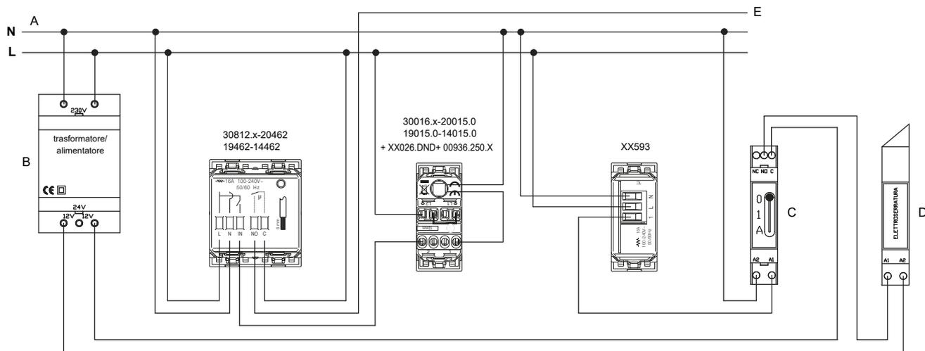
5. Collegamento in presenza di lettore, sensore radar connesso (con funzione di scambio relè) e tasto interno camera per DND (con segnalazione integrata)
