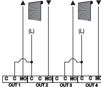
**COLLEGAMENTO DI 1 TAPPARELLA E 2 LUCI • CONNECTION OF 1 ROLLER SHUTTER AND 2 LIGHTS**
