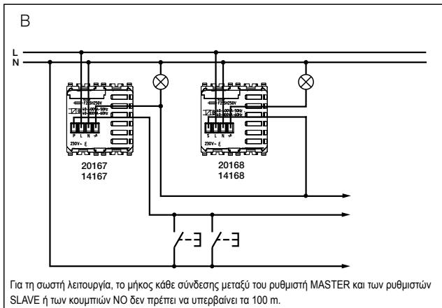
Συνιστάται η τοποθέτηση των καλωδίων σύνδεσης στο πίσω μέρος του κουτιού με τρόπο ώστε να αποφεύγεται η επαφή με το σώμα του ρυθμιστή.
