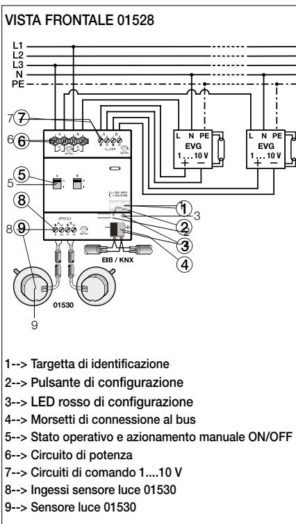
Regolatore di luminosità, 2 ingressi per 01530, 2 uscite a relè NO 16A 250 V~, 2 uscite 1-10 V, standard KNX, installazione su guida DIN (60715 TH35), occupa 4 moduli da 17,5 mm.
