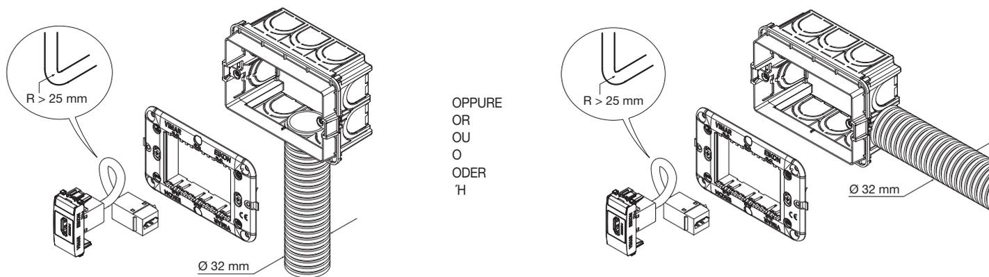
**R:** Raggio di curvatura del cavo - Radius of curvature of the cable - Rayon de courbure du câble
