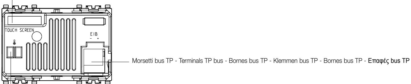
Morsetti per sensore di temperatura - Input for temperature sensor - Entrée pour capteur de température
