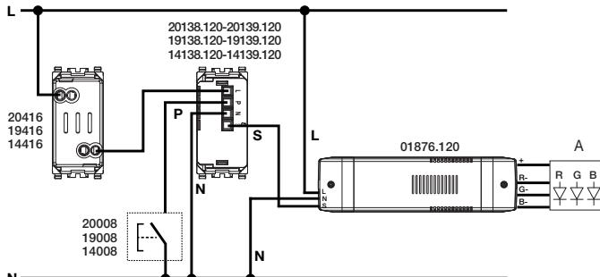
A: Modulo LED RGB - Strisce LED RGB • Module RGB LED - Strip RGB LED
