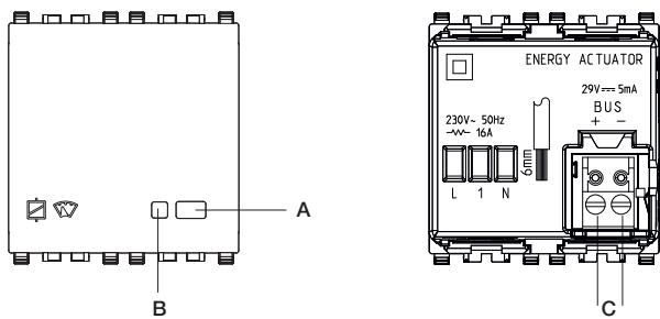
A: Pulsante di configurazione - Configuration button - Bouton de configuration
