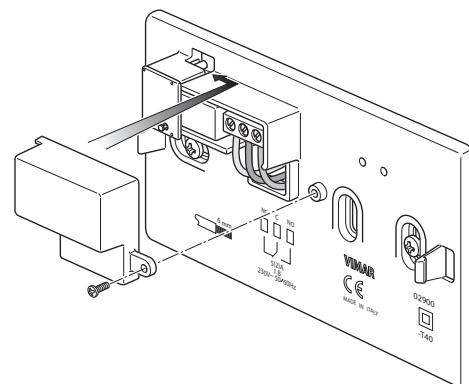
**3. Fissare la vite di sicurezza - Fasten the safety screw**
