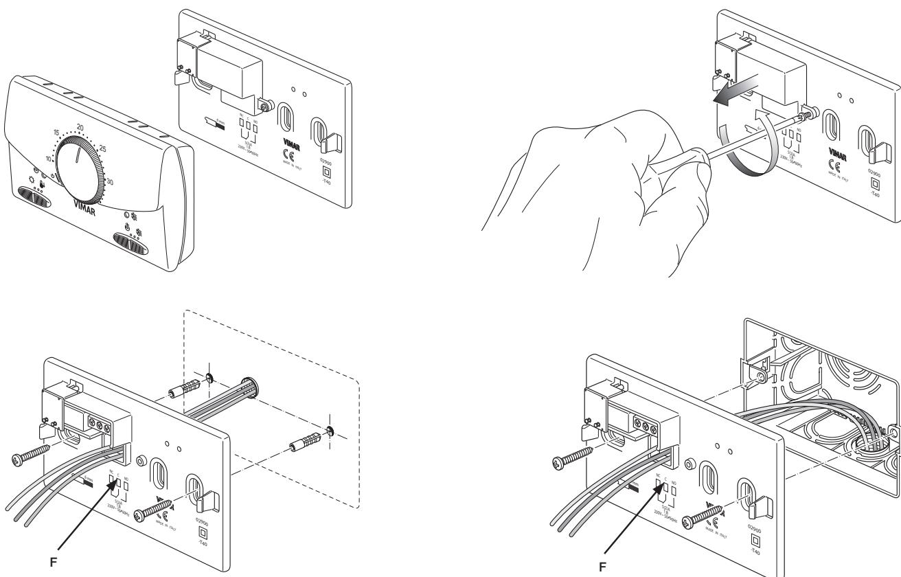
F: Foro per il passaggio dei cavi da fissare ai morsetti • Hole for the cables to be fixed to the terminals • Orifice pour le passage des câbles à fixer aux bornes
