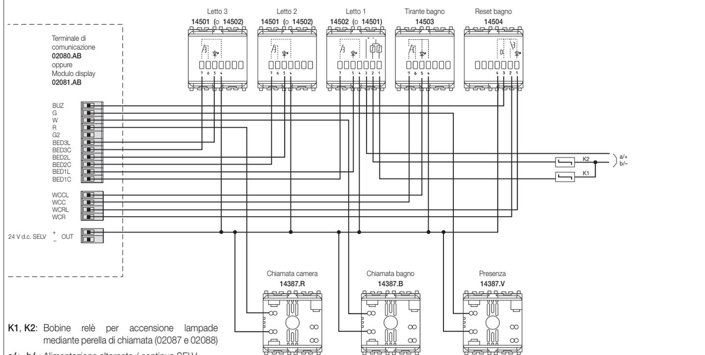
**K1, K2:** Bobine relè per accensione lampade mediante perella di chiamata (02087 e 02088)
