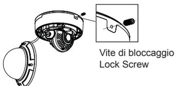
2) Posizionare la dima per la foratura dove si intende fissare la telecamera, quindi praticare i 4 fori per le viti e il foro per i cavi (nel caso si intenda far passare i cavi attraverso la base di montaggio) in base alla dima.
