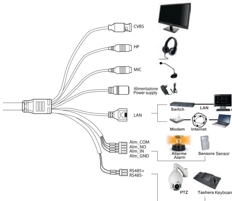
Per collegare il PC e la telecamera IP fare riferimento alla figura sopra. Prima di eseguire il collegamento, collegare i dispositivi esterni, quindi collegare l'alimentazione.
