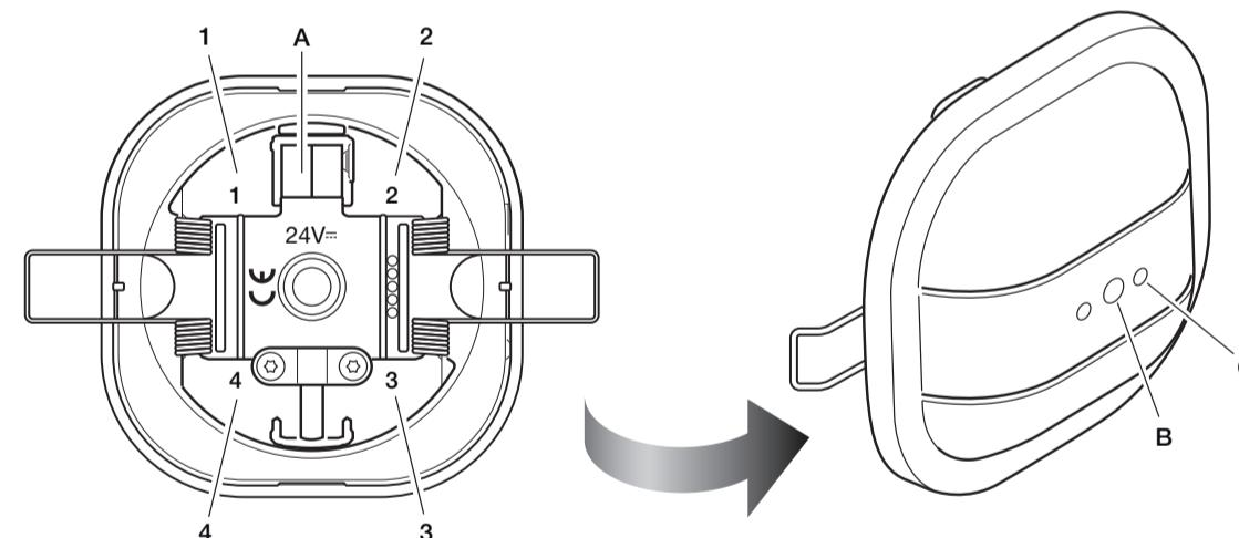
**1-4:** Settori disattivabili separatamente (tramite parametrizzazione). Per la numerazione si veda il retro del rivelatore
