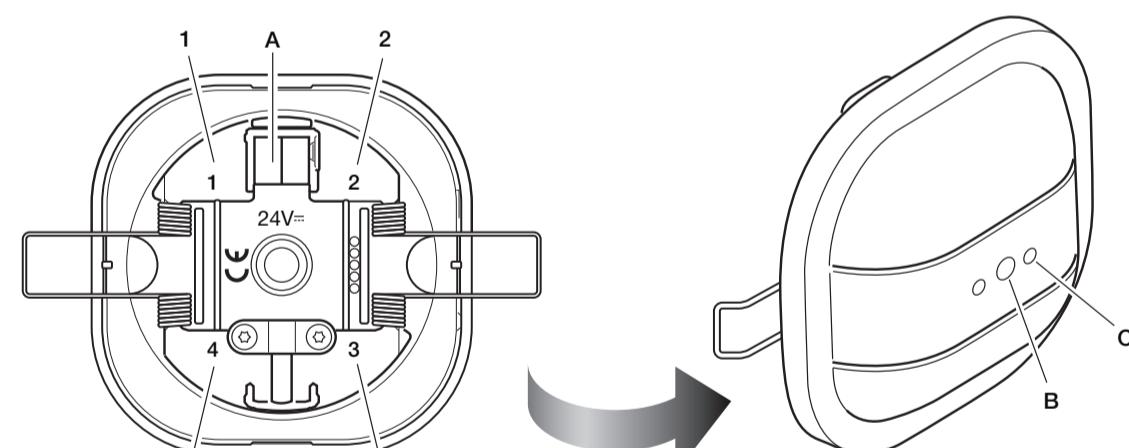
1-4: Sectores que pueden desactivarse por separado (mediante configuración). Para la numeración, observe la parte posterior del detector
