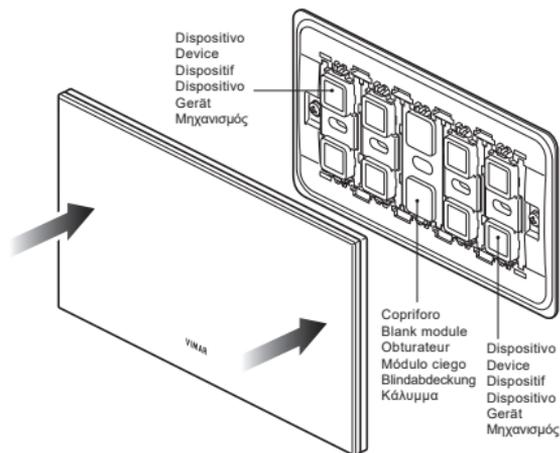
**ATTENZIONE:** non è possibile installare dispositivi nel modulo centrale. Chiuderlo con copriforo 21041.
