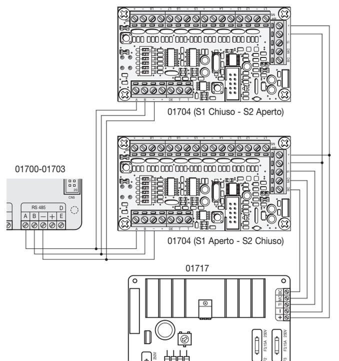
Attenzione: Soltanto uno dei moduli 01704 collegati all'alimentatore 01717 deve avere i morsetti TI, MC e BC collegati ad esso e i ponticelli S1 e S2 in posizione di aperto e chiuso rispettivamente.
