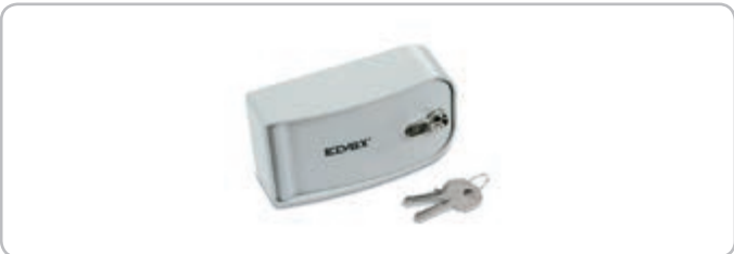
Behälter als Sicherheit, zur Verhinderung zum Zugang und Benutzbarkeit der Steuerbedienungsanordnung. Wird in Serie geliefert, komplett mit Schalttasten (auf-unter) (öffne-schließe und für die Entblockung). Aus Aluminium Druckguss - IP54 Kode EDP4
