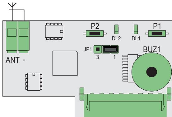
Ricevente a 2 canali a innesto 433 MHz rolling code/codice fisso per schede di comando automazioni SL24.T e SW24.T (connessione su connettore CNRX).
