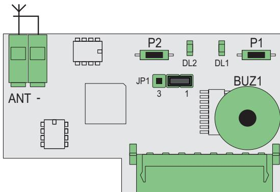
Receptor enchufable de 2 canales 433 MHz código variable / código fijo para las tarjetas de control de automatización SL24.T y SW24.T (conexión en el conector CNRX).
