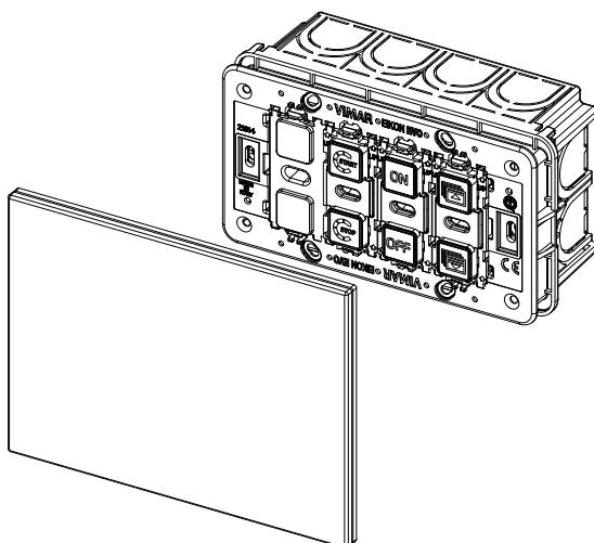
Aggiornare la placca in modo che i contatti centrali combacino perfettamente con quelli dell'apparecchio di comando 21540.1 e attendere che il dispositivo torni in standby prima di iniziare ad utilizzarlo.
