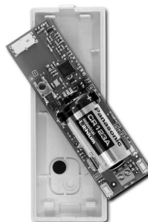
Fissare il contenitore con 2 viti in corrispondenza dei fori posti sul fondo del contenitore stesso. Così facendo si rende attivo anche l'antistrappo del dispositivo radio.
