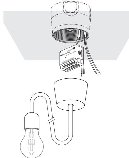
Attuatore EnOcean multifunzione con uscita a relè NO 8 A 230 V~ programmabile con funzione interruttore per comando locale, ingresso locale trasferibile come comando ON/OFF verso altri attuatori EnOcean, alimentazione 230 V~ 50 Hz.
