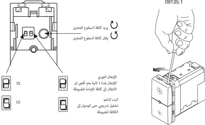
وحدة تحكم عالمية 230 فولت - 50 هرتز للمصابيح المتوهجة 40-400 وات، محولات إلكترونية 40-300 فولت أمبير، مصابيح CFL قابلة لتخفيف الضوء 200-100 وات، مصابيح LED قابلة لتخفيف الضوء 200-3 وات، لمغذيات LED إلكترونية، التحكم تشغيل/إيقاف التشغيل والضبط بواسطة أزرار مدمجة أو بواسطة نقاط متعددة بأزرار مفتوحة عادةً، وظيفة رئيسية لـ 14137، ضبط الحد الأدنى لكثافة الإضاءة، تحديد الموقع في الظلام، جهاز غير قابل للتكيف في حاويات Isoset.
