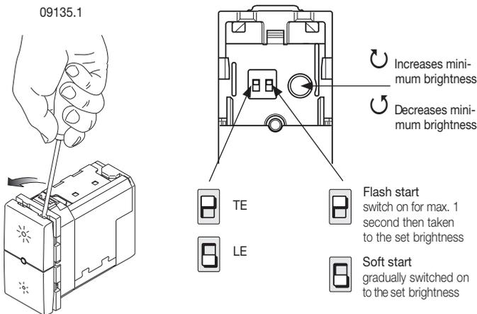
Variateur 230 V~ 50 Hz pour: lampes incandescentes 40-400 W, transformateurs électroniques 40-300 VA, lampes CFL 10-200 W, LED lampes 3-200 W et transformateurs électroniques à LED, commande et réglage par poussoir incorporé ou en différents endroits par poussoirs NO, fonction MASTER pour 14137, réglage puissance minimum, localisation dans l'obscurité, gris. Pas pour enveloppes Isoset.
