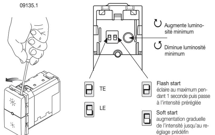
Variador 230 V~ 50 Hz para: lámparas incandescentes 40-400 W, transformadores electrónicos 40-300 VA, lámparas CFL 10-200 W, lámparas de LED 3-200 W y transformadores electrónicos de LED, mando con pulsadores incorporados o desde varios puntos con pulsadores NO, función MASTER para 14137, ajuste potencia mínima, visible en la oscuridad, gris. No para cajas Isoset.
