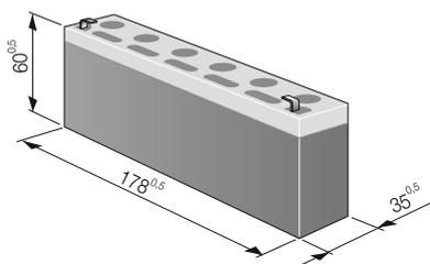
N.B. Si raccomanda di rispettare le polarità in fase di installazione (rosso=positivo, nero=negativo). In caso di batteria scarica e con tensione inferiore ai 10,5 V la sirena interrompe la riproduzione delle segnalazioni sonore mantenendo però quelle luminose.
