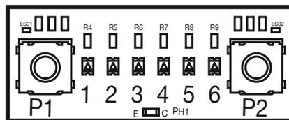
I menù di programmazione sono identificati mediante combinazioni di lampeggio dei LED (dal n° 3 al n° 6), all'interno dei quali la selezione e navigazione avviene tramite i pulsanti P1 e P2.
