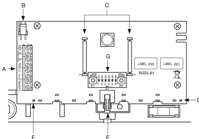
A: Morsetti di collegamento (per il dettaglio si veda fig. MORSETTI)
