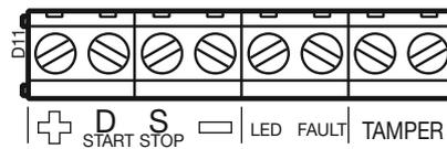
+ : Positivo dell'alimentazione. Nel caso di collegamento a 2 fili svolge anche la funzione di morsetto di allarme.
