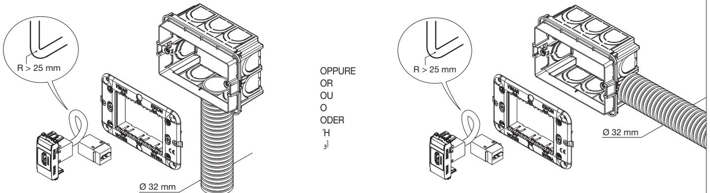
R: Raggio di curvatura del cavo • Radius of curvature of the cable • Rayon de courbure du câble
