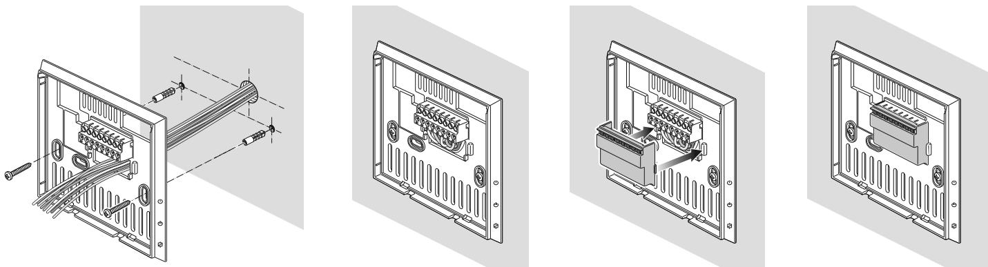
Attenzione: Serrare le viti della staffa a muro, applicando una coppia non eccessiva, in modo da evitare deformazioni della stessa.
