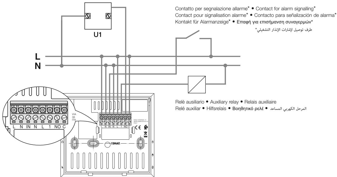
\* Genera una notifica di allarme ma non disattiva il relè di uscita (NO-C) • \* Generates an alarm notification but does not deactivate the output relay (NO-C)
