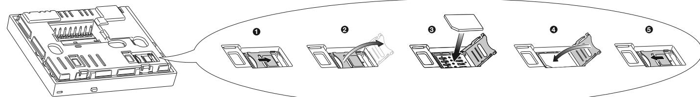
Fissare il termostato alla staffa mediante gli appositi agganci evidenziati in figura • Fix the thermostat to the bracket using the dedicated attachments shown in the figure
