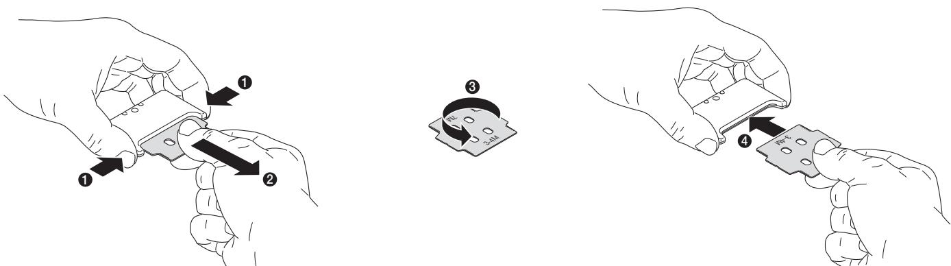
ESTRAZIONE DELLA PLACCA • COVER PLATE EXTRACTION • DÉMONTAGE DE LA PLAQUE • EXTRACCIÓN DE LA PLACA • ENTNAHME DES ABDECKKRAHMENS
