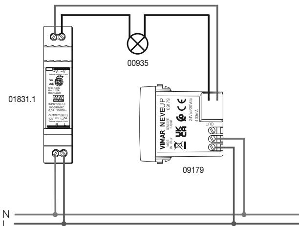
**3. Collegamento a centralina di comando o a dispositivo con ingressi privi di potenziale • Connection to control switchboard or to device with potential-free inputs**
