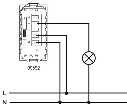
Esempio di circuito luce con pulsanti e relè in un nuovo impianto • Example of a light circuit with push buttons and relays in a new system
