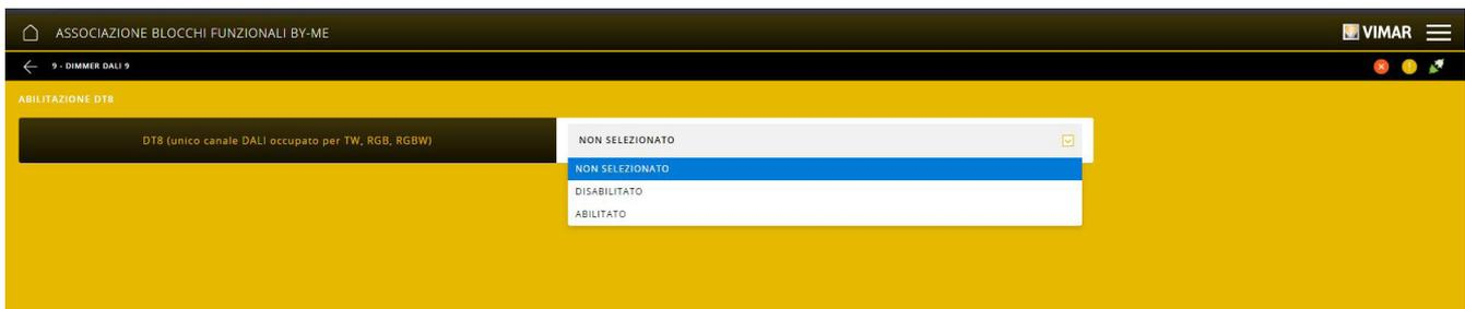
Nach Anwahl des Funktionsblocks DT8 (aktiviert oder deaktiviert) müssen die Kanäle zur Realisierung der verschiedenen Komponenten R, G, B und W definiert werden (in diesem Fall wurde der DIMMER RGB/RGBW gewählt).
