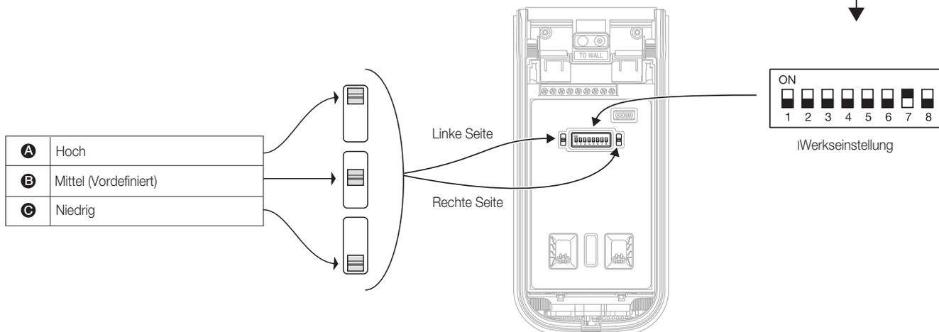
\* Alarmausgänge; ON/OFF der einzelnen Ausgänge mittels DIP-Schalter Nr.3
