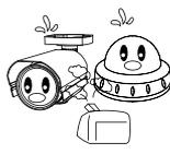
Non installare o utilizzare la telecamera in ambienti con valori di umidità elevati.
