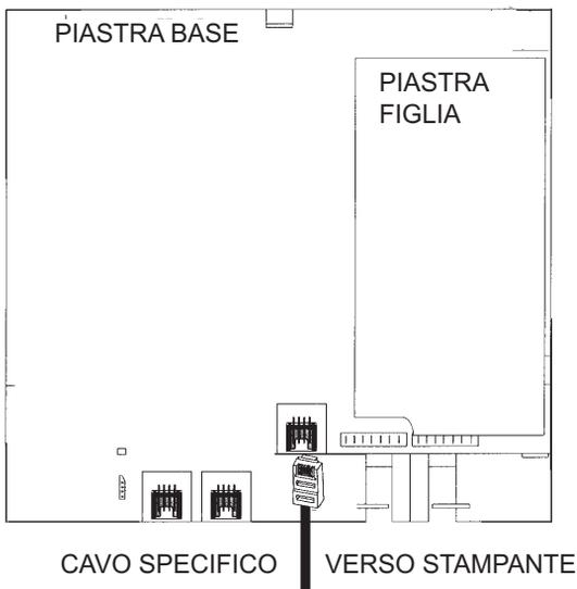
**AVVERTENZA:** Per collegare il cavo verso la stampante, occorre disconnettere i cavi di alimentazione del centralino e le connessioni alle linee esterne.
