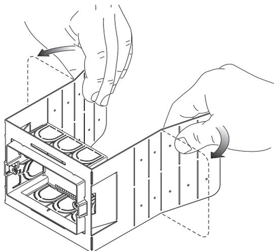
Die Halterung je nach Einbauhöhe der Dose entsprechend den am Produktetikett angegebenen Maßen biegen.
