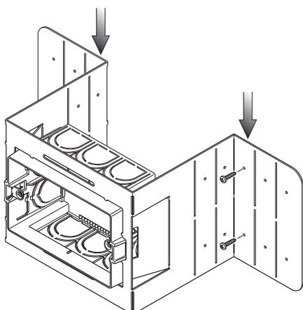
Fixer l'étrier à partir des orifices les plus proches de son pli de base (en utilisant éventuellement des accessoires appropriés tels que des rallonges pour visseuse, etc.).
