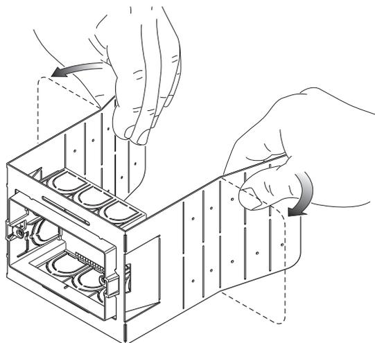
Plier en fonction des cotes indiquées sur l'étiquette de l'article, en fonction de la hauteur à laquelle la boîte sera posée.
