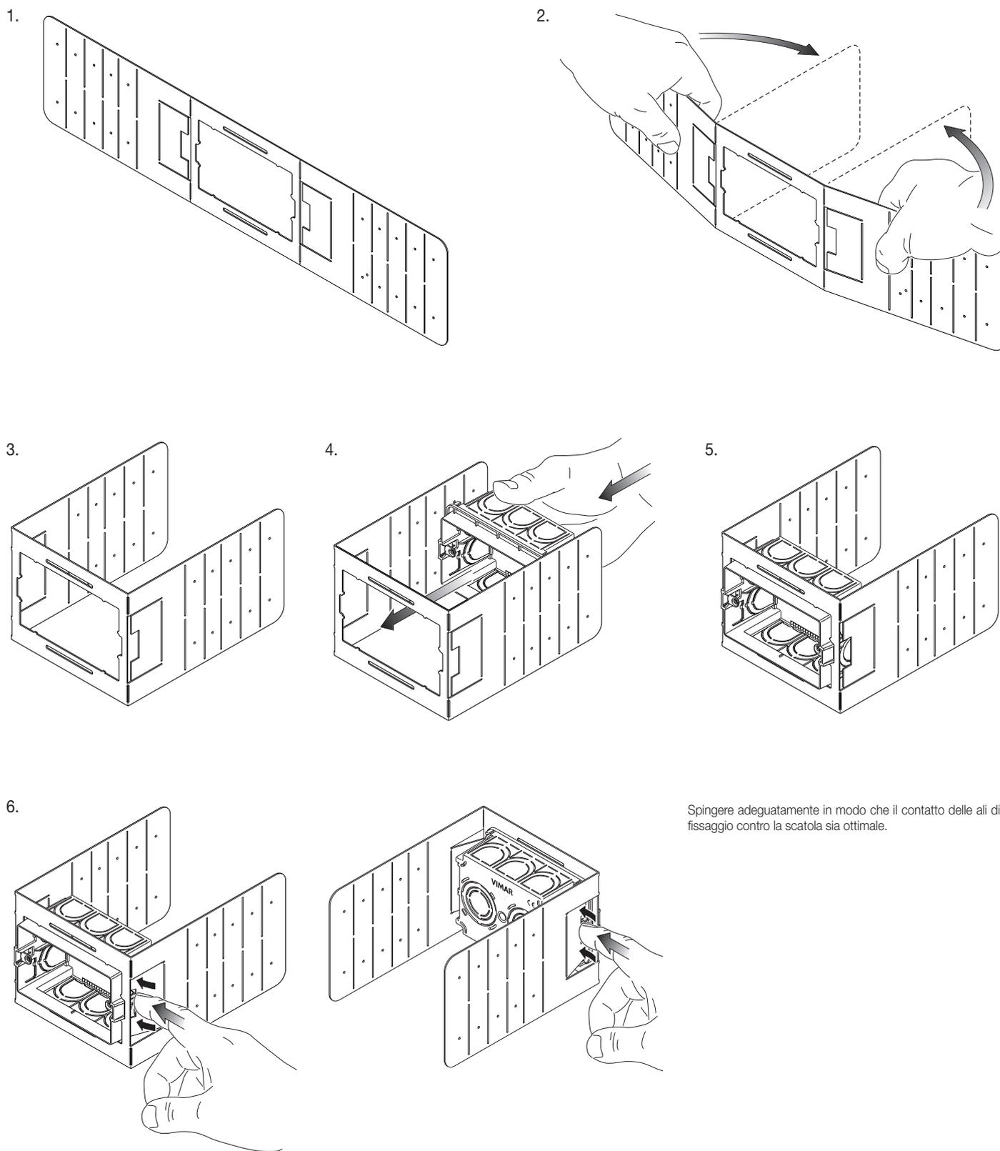
Spingere adeguatamente in modo che il contatto delle ali di fissaggio contro la scatola sia ottimale.
