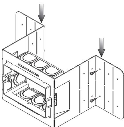
Il fissaggio della staffa deve essere realizzato utilizzando i fori più vicini alla piega di base della staffa (eventualmente impiegando accessori adatti quali prolunghe per avvitatore, ecc.).
