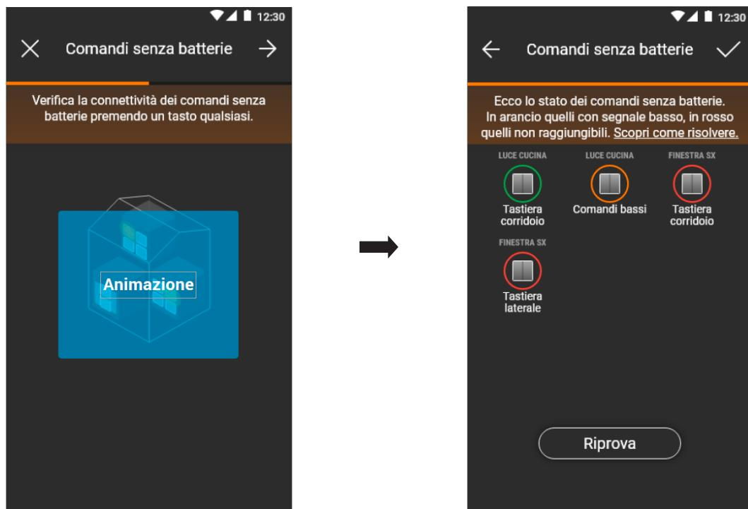
Al termine del test saranno visualizzati tutti i comandi art. 03925 e i rispettivi ambienti; in verde saranno evidenziati quelli con potenza di segnale buona, in arancione quelli con potenza scarsa e in rosso quelli non raggiunti o con potenza insufficiente. Selezionando
