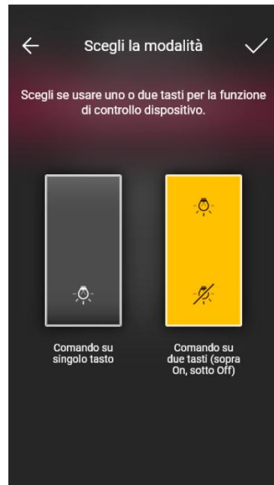
A questo punto si potranno andare a configurare i rimanenti tasti del comando radio 03295 con la medesima procedura oppure concludere l'operazione mediante
