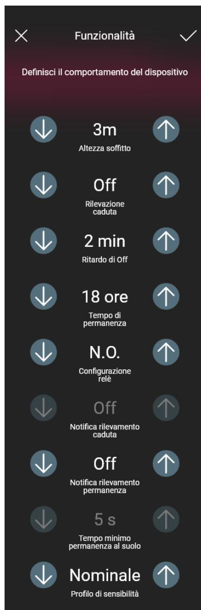
Altezza soffitto: altezza in m della posizione dove è installato il sensore
