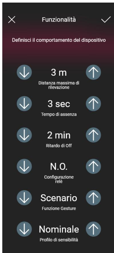
Distanza massima di rilevazione: distanza in m entro la quale viene rilevata la presenza
