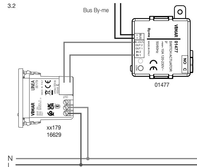
4. Collegamento a relè di potenza per comando di un carico a tensione di rete
