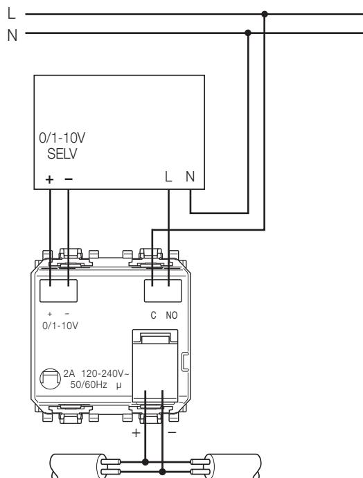
Μέγιστη απόσταση μεταξύ εκκινητή και βαλβίδας: 50 m. Χρησιμοποιείτε συνεστραμμένο καλώδιο με ελάχιστη διατομή 0,5 mm<sup>2</sup> (κωδ. 01840).
