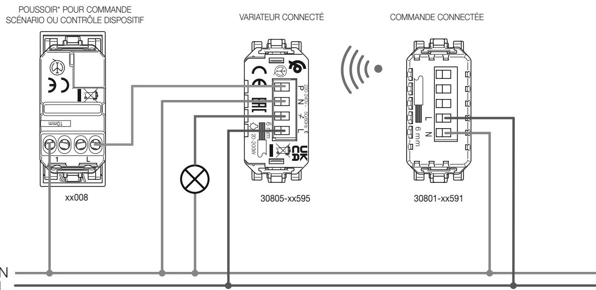
**EXEMPLE DE RACCORDEMENT AVEC APPAREIL DE COMMANDE STORE**
