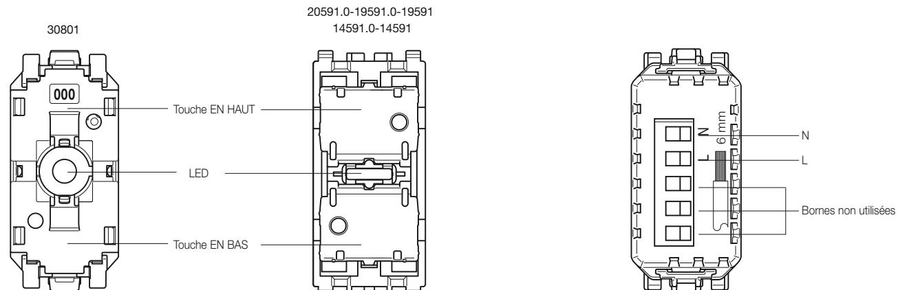
**EXEMPLE DE RACCORDEMENT AVEC VARIATEUR**
