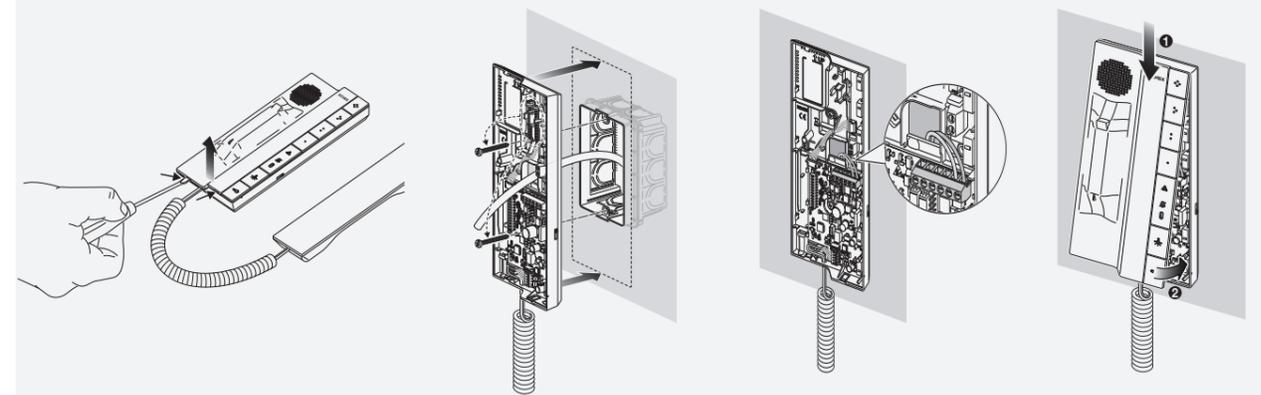
Das Haustelefon kann mit den Dübeln, der runden ø 60 mm, rechteckigen 3-Modul- oder quadratischen Vimar Unterputzdose British Standard direkt an der Wand installiert werden.
