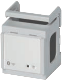
0K14597.01 Passerelle Wi-Fi Bluetooth® pour l'intégration, la configuration et la supervision du système View Wireless via le Cloud et une application pour smartphone et tablette, alimentation 100-240 V 50/60 Hz, installation sur rail DIN (60715 TH35), occupe 2 modules de 17,5 mm
