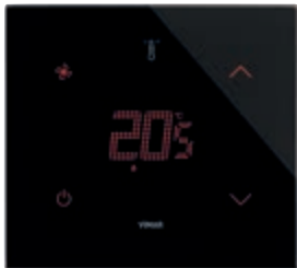
21814.F.76 Termostat cu ecran tactil (încălzire şi aer condiţionat), comandă VENTILOCONVECTOR cu 3 viteze şi proporţională, control ON/OFF (clasa I, contribuţie 1%), PWM, PID (clasa IV, contribuţie 2%), poate fi interfaţat cu actuatorul 01466.1 pentru termostat de cameră modulant (clasa V, contribuţie 3%), 1 intrare pentru senzor 20432, 19432 sau 14432 sau senzor cu fir 02965.1, 1 intrare digitală programabilă, retroiluminare cu leduri RGB, nero diamante - 2 module. Adâncime: 30,2 mm
