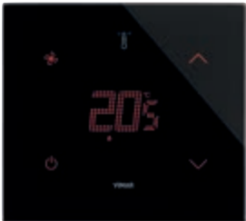
21514.F.76 Termostat cu ecran tactil (încălzire și aer condiționat), comandă VENTILOCONVECTOR cu 3 viteze și proporțională, control ON/OFF (clasa I, contribuție 1%), PWM, PID (clasa IV, contribuție 2%), poate fi interfațat cu actuatorul 01466.1 pentru termostat de cameră modulant (clasa V, contribuție 3%), 1 intrare pentru senzor 20432, 19432 sau 14432 sau senzor cu fir 02965.1, 1 intrare digitală programabilă, retroiluminare cu leduri RGB, nero diamante - 2 module. Adâncime: 30,2 mm
