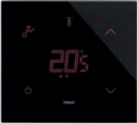
21514.H.76 Termostat cu ecran tactil (încălzire și aer condiționat), comandă MAKE UP ROOM și DO NOT DISTURB, control ON/OFF (clasa I, contribuție 1%), PWM, PID (clasa IV, contribuție 2%), poate fi interfațat cu actuatorul 01466.1 pentru termostat de cameră modulant (clasa V, contribuție 3%), 1 intrare pentru senzor 20432, 19432 sau 14432 sau senzor cu fir 02965.1, 1 intrare digitală programabilă, retroiluminare cu leduri RGB, nero diamante - 2 module. Adâncime: 30,2 mm
