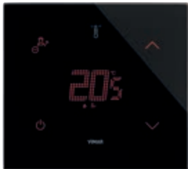
21814.H.76 Termostat cu ecran tactil (încălzire şi aer condiţionat), comandă MAKE UP ROOM şi DO NOT DISTURB, control ON/OFF (clasa I, contribuţie 1%), PWM, PID (clasa IV, contribuţie 2%), poate fi interfaţat cu actuatorul 01466.1 pentru termostat de cameră modulant (clasa V, contribuţie 3%), 1 intrare pentru senzor 20432, 19432 sau 14432 sau senzor cu fir 02965.1, 1 intrare digitală programabilă, retroiluminare cu leduri RGB, nero diamante - 2 module. Adâncime: 30,2 mm
