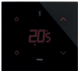
21814.S.76 Termostat cu ecran tactil (încălzire şi aer condiţionat), comandă STAR configurabilă, control ON/OFF (clasa I, contribuţie 1%), PWM, PID (clasa IV, contribuţie 2%), poate fi interfaţat cu actuatorul 01466.1 pentru termostat de cameră modulant (clasa V, contribuţie 3%), 1 intrare pentru senzor 20432, 19432 sau 14432 sau senzor cu fir 02965.1, 1 intrare digitală programabilă, retroiluminare cu leduri RGB, nero diamante - 2 module. Adâncime: 30,2 mm
