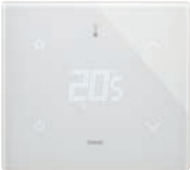
21514.S.70 Termostat cu ecran tactil (încălzire și aer condiționat), comandă STAR configurabilă, control ON/OFF (clasa I, contribuție 1%), PWM, PID (clasa IV, contribuție 2%), poate fi interfațat cu actuatorul 01466.1 pentru termo- stat de cameră modulant (clasa V, contribuție 3%), 1 intrare pentru senzor 20432, 19432 sau 14432 sau senzor cu fir 02965.1, 1 intrare digitală programabilă, retroiluminare cu leduri RGB, bianco diamante - 2 module. Adâncime: 30,2 mm
