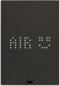
32042.G Aparat de comandă XT pentru domotică By-me Plus, funcție de termostat pentru controlul temperaturii ambiante (încălzire și aer condiționat), gestionare instalații cu 2 și 4 țevi, comandă ventiloconvector cu 3 viteze și proporțională, dispozitiv de control al temperaturii de clasa I (contribuție 1%) în modul ON/OFF, de clasa IV (contribuție 2%) în modul PID, poate fi interfațat cu actuatorul cu ieșiri analogice proporționale 01466.1 pentru a realiza un termostat de cameră modulănt de clasa V (contribuție 3%), funcție umidostat cu comandă On/Off comparativ cu un parametru setat, funcție COV (compuși organici volatili) cu comandă On/Off sau de reapelare pentru 2 scenarii, funcție 2 butoane cu configurație ca 1 buton basculant cu led de identificare a stării, matrice cu leduri centrală pentru personalizarea simbolurilor sau a animației, funcție de proximitate, retroiluminare cu leduri albe, negru - 2 module frontale
