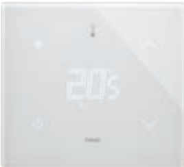
21514.F.70 Termostat cu ecran tactil (încălzire și aer condiționat), comandă VENTILOCONVECTOR cu 3 viteze și proporțională, control ON/OFF (clasa I, contribuție 1%), PWM, PID (clasa IV, contribuție 2%), poate fi interfațat cu actuatorul 01466.1 pentru termostat de cameră modulant (clasa V, contribuție 3%), 1 intrare pentru senzor 20432, 19432 sau 14432 sau senzor cu fir 02965.1, 1 intrare digitală programabilă, retroiluminare cu leduri RGB, bianco diamante - 2 module. Adâncime: 30,2 mm
