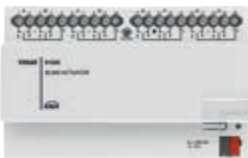
Δ 01525 Actuator pentru 8 jaluzele cu ieșire cu releu 6 A 230 V~ 50/60 Hz, standard KNX, 8 module de 17,5 mm
