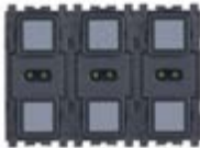
21540.1 6 butoane independente sau 3 basculante, 6 LED RGB independente - 3 module. Adâncime: 38 mm
