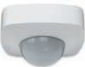
02690 Pentru iluminat, lămpi incandescente 2000 W, CFL 10-1000 W, LED 100 W, 220-240 V~ 50/60 Hz, montare pe tavan
