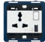
■ 19266.A.B SICURY 2P+T 13 A 250 V~ multistandard cu Întrerupător 2P și ieșire USB tip A. Adâncime: 21 mm
