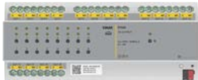
▲ 01532 Actuator 16 ieșiri cu releu NO 10 A 230 V~ 50/60 Hz, standard KNX Secure, instalare pe șină DIN (60715 TH35), ocupă 12 module de 17,5 mm
