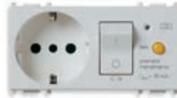
14286.SL 16 A P30 250 V~, 1P+N C 16 - 4 module. Adâncime: 38,7 mm
