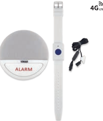
03890 Dispositivo vivavoce di telesoccorso per chiamata via rete cellulare LTE di numeri predefiniti. La chiamata vivavoce viene avviata premendo il pulsante "Alarm" o tramite il pulsante dell'accessorio bracciale/pendaglio (inclusi). Il dispositivo consente anche la ricezione di chiamate esterne con risposta automatica
