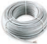
01840.E Câble pour système Bus By-me, 2x0,50 mm², avec gaine en LSZH, Classe CPR Eca, compatible pour l'installation de câbles d'énergie de catégorie I (U0 = 400 V), blanc - 100 m
