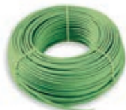
01890.E Câble pour systèmes KNX, 2x2x0,8 mm, avec gaine en LSZH, Classe CPR Eca, conforme au standard KNX, compatible pour l'installation de câbles d'énergie de catégorie I (U0 = 400 V), vert - 100 m
