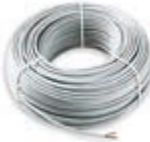
01841.E Câble pour système Bus By-me, 2x0,50 mm², blindé, avec gaine en LSZH, Classe CPR Eca, compatible pour l'installation de câbles d'énergie de catégorie I (U0 = 400 V), pour utilisations en milieu marin, blanc - 100 m
