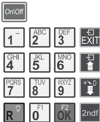
La tecla no tiene ninguna función porque el programador se alimenta del bus. Por este motivo, tampoco se encuentra disponible la función de autoapagado. Mediante las teclas y del programador, seleccionar la opción siguiente del menú principal:
