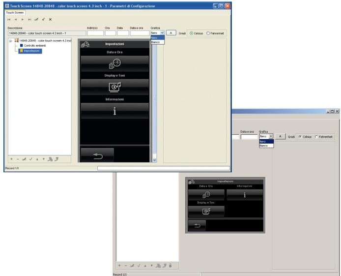
Software Configuratore touch screen per Well-contact Plus
